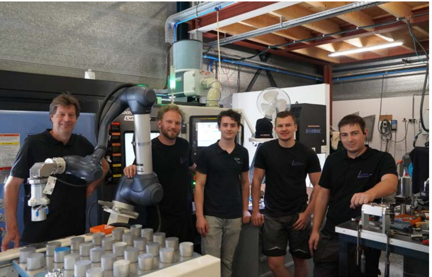
Ruud Jansen (l) met zijn team voor de geautomatiseerde Doosan Lynx. De CNC-draaimachine is voorzien van hogedrukkoeling en een olieniveau filtratiesysteem van Dormatec. (foto's Tim Wentink)
