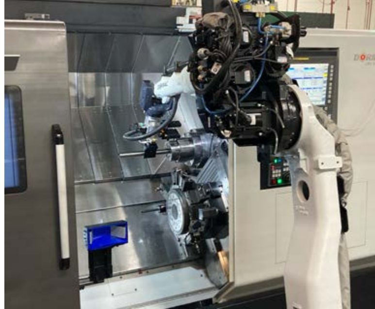
De Doosan TT1800SY CNC-draicentra beschikken over dubbele turrets en Y-as. Door elke machine te beladen met een eigen robot is HFI minder kwetsbaar.
