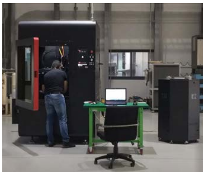
De nieuwe MX-Fab1 is de productieversie van de metaalprinter waarmee de Koreaanse machinebouwer heel precies tot zes metalen kan combineren.
