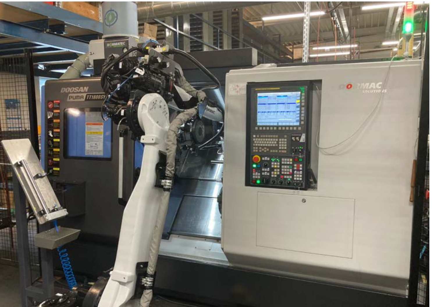
HFI produceert in twee identieke cellen, telkens opgebouwd rond een Doosan TT1800SY, geautomatiseerd 15 verschillende varianten van een complex product dat meerdere productiestappen ondergaat.
