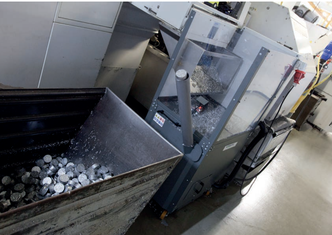
Briketteerpersen verkleinen het volume en halen koelsmeer middel terug uit de spanen.
