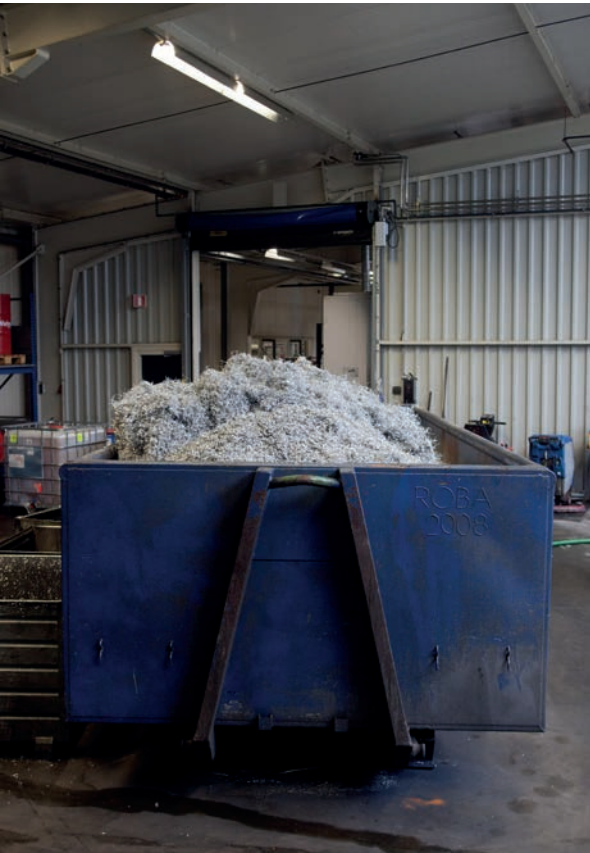
Brinks Metaalbewerking in Vriezenveen produceert ruim 400 ton aluminium spanen per jaar
