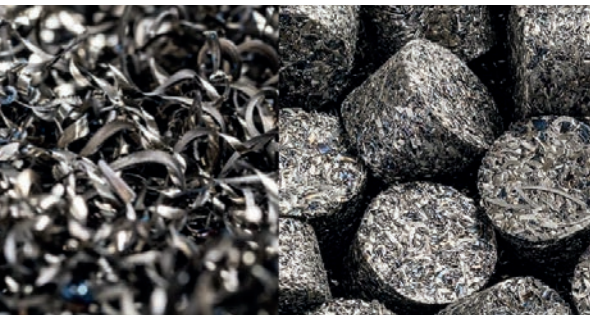
De kleine brikettepers kan 30 tot 40 kg aluminium spanen per uur verwerken, waardoor Brinks in plaats van drie volle spanenbakken per ploeg, nu pas na drie dagen een volle bak briketten moet wisselen.
